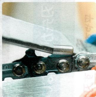
上刃全面にヤスリを当て、上刃の角度が約60度程度になるようヤスリを傾け、研いで下さい。上刃に刃をつけることが、切れる目立てのコツです。丸ヤスリでは調整にくい上刃の研ぎが、平型ヤスリだと直感的にできます。
